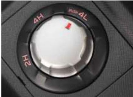
Einschalten des 4x4-Modus und der Geländereduzierung über den Drehknopf in der Mittelkonsole.
